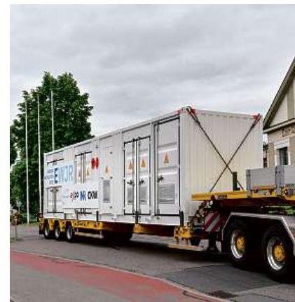
67 Tonnen schwer: Der Batteriespeicher braucht Platz. Angeliefert wird er in zwei Containern. PRESSEBILD
